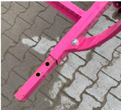
02 Die Verschraubung der Zwischenstücke erfolgt mit jeweils 4 Schrauben M12 (SW19, Festigkeit min. 8.8) mit selbstsichernden Muttern.
