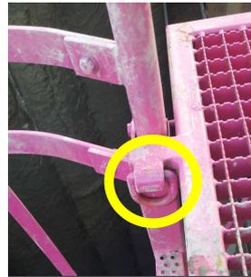
02 2 Anschlagpunkte für die Anbringung von Hebeketten sind am oberen Podest vorgesehen.
