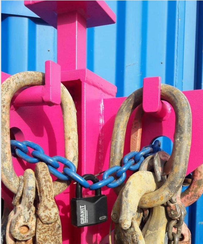
01 Zum Schutz vor Diebstahl kann eine hochfeste Kette (Güteklasse 10; Länge ca. 1,5 m; Ösenstärke  $\geq 10$  mm) durch alle Aufhänger der Kettengehänge und durch die Arme des Kettenständers gezogen werden.
